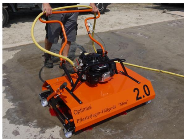
MACHINE A JOINTOYER LES PAVES « MINI » 2.0
